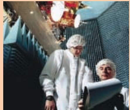
El Envisat se encuentra en una cámara sin eco de Astrium para comprobar la compatibilidad de las diferentes frecuencias de radio.
