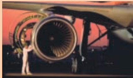
Un ingeniero dedicándose al mantenimiento del motor de un A310
